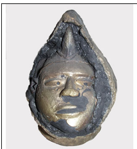
3. Wosk pokryty gliną następnie wytopiony I zastąpiony metalem. Gлина częściowo usunięta odstania metalowy przedmiot.
