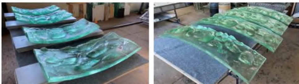
Fot. 5. Szklą gięte wklęsłe (po lewej) i wypukłe (po prawej) Źródło: (autor)
