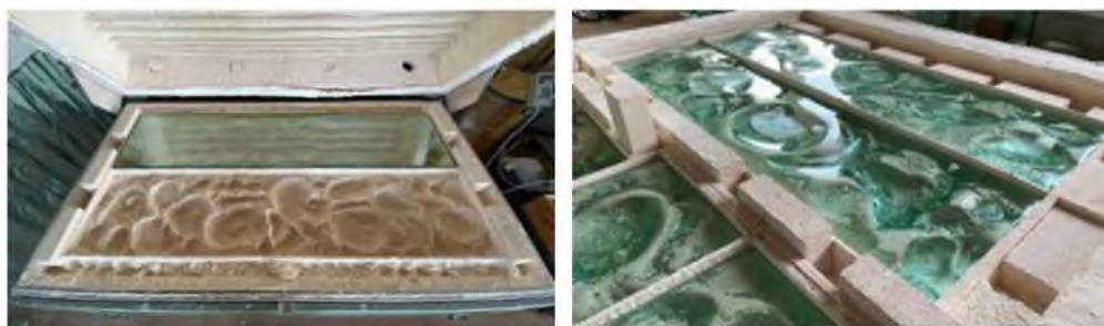
Fot. 3. Szkło i ręczna forma przed procesem odlewu (po lewej) oraz po odlewie (po prawej) Źródło: (autor)
