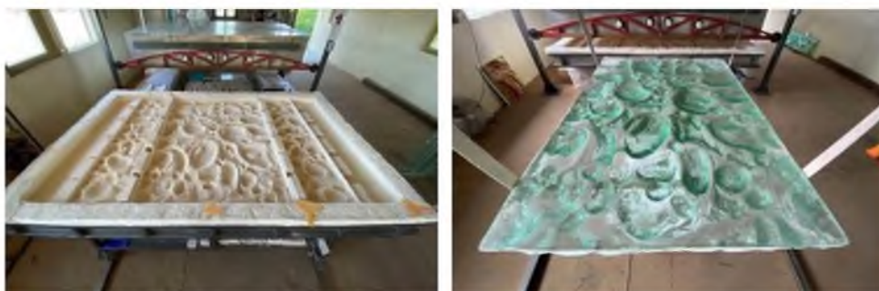
Fot. 7. Forma do odlewu (po lewej) oraz gotowe szkło do przygotowania grafiki (po prawej) Źródło: (autor)
